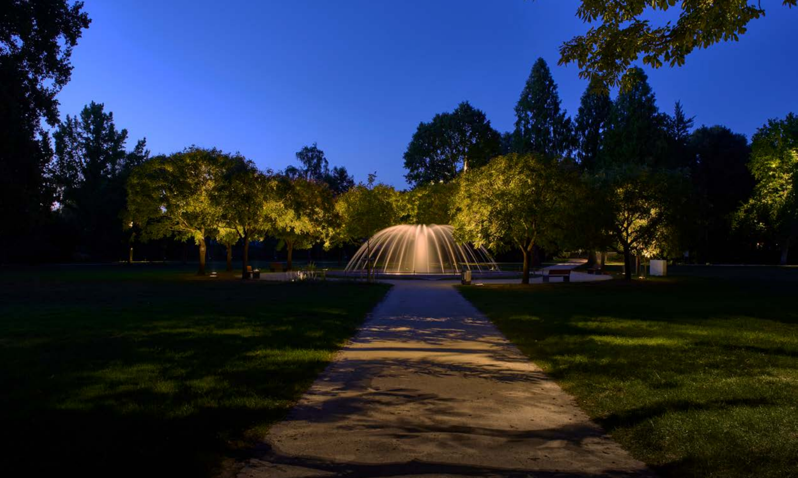
Abb.: Das Licht aus den LED-Strahlern im Baum bildet scharfe und unscharfe Projektionen von Blättern und Ästen ab, so wie es durch das Sonnen- oder Mondlicht entstehen würde. Gleichzeitig wird der Weg gut ausgeleuchtet.
