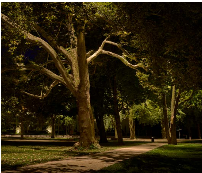
Abb.: Uplights kommen nur punktuell bei niedrigeren Pflanzen zum Einsatz, sie setzen dadurch vereinzelte Akzente. Die Wegbeleuchtung lebt von den Projektionen, die sich auch auf der Grünfläche weiter fortsetzen.
