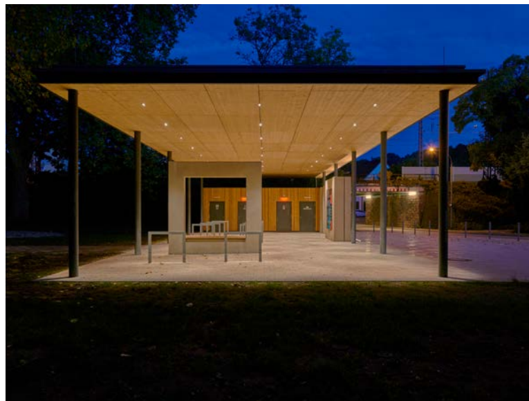
Abb.: Im Pavillon sind entblendete Downlights kaum wahrnehmbar in der Decke integriert. Sie erzeugen ein helles und angenehmes Lichtniveau, das für Sicherheit sorgt. Bodeneinbauleuchten zeichnen die Architektur nach.
