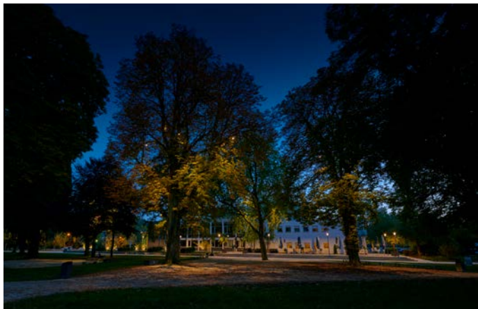
Abb.: Der natürliche Effekt des diffusen Lichts gelingt über ein Leuchtenmodell, das jedoch drei Abstrahlwinkel mit 10°, 28° und 40° liefert. Die Lichtverteilung zeigt sich dadurch von kontrastreich bis ausgewogen.
