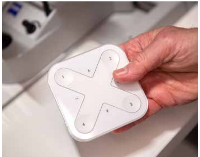
Abb.: Von den »Xpress-Funkschaltern von Casambi liegt je einer in den zwei Untersuchungszimmern, ein weiterer befindet sich am Empfang, um bei Praxisabschluss das gesamte Licht mit einem Handgriff auszuschalten.
